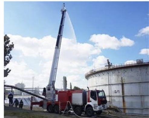
Пожарный пеноподъемник ППП-55, построенный на базе шасси IVECO Trakker AD 410 T 50 8x4, пополнил парк пожарной автотехники «Саратовского нефтеперерабатывающего завода». ППП-55 в данной комплектации (оснащенный пожарным насосом, системой пеносмешения и пенобаком) является уникальным, ранее не производимым российскими производителями пеноподъемников, с рабочей высотой 55 м.
