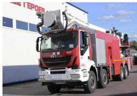
Пожарный пеноподъемник ППП-55 производства ООО «КОМПАНИЯ ВИТАНД», построенный на базе шасси IVECO Trakker AD 410 T 50 8x4, эксплуатируется в парке пожарной автотехники «Саратовского нефтеперерабатывающего завода». ППП-55 является уникальным, ранее не производимым российскими производителями пеноподъемников, с рабочей высотой 55 м.
